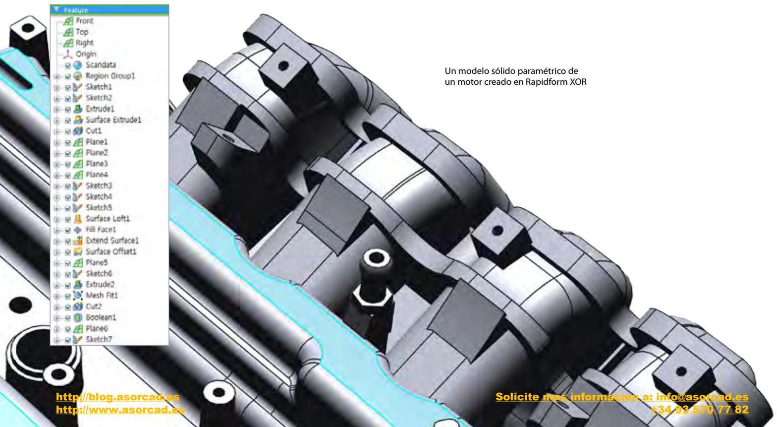
Un modelo sólido paramétrico de un motor creado en Rapidform XOR
