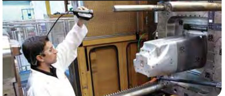
Con la cámara 3D MaxSHOT, todo lo que tiene que hacer es colocar algunos objetivos codificados, ya sea sobre el objeto que desea medir o en su entorno, tomar varias series de fotografías convergentes e iniciar el proceso de ajuste de bloques (triangulación de la imagen). A través de este proceso, los reflectores ubicados sobre el objeto pueden reconstituirse fácilmente en 3D, y las barras patrón obtenidas en el volumen de la medición permiten efectuar el escalado del modelo.
