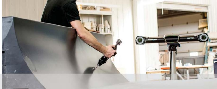
La **máquina óptica CMM portátil HandyPROBE Next™** ofrece precisión de medición que no se ve alterada por las inestabilidades de ningún entorno. Sin configuración de medición rígida, la pieza, el rastreo óptico y la sonda inalámbrica se pueden mover en cualquier momento durante la secuencia de medición. Gracias a su diseño específico para uso en plantas de producción, el sistema ofrece flexibilidad sin par y un volumen de medición más amplio que el de otras CMM portátiles.
