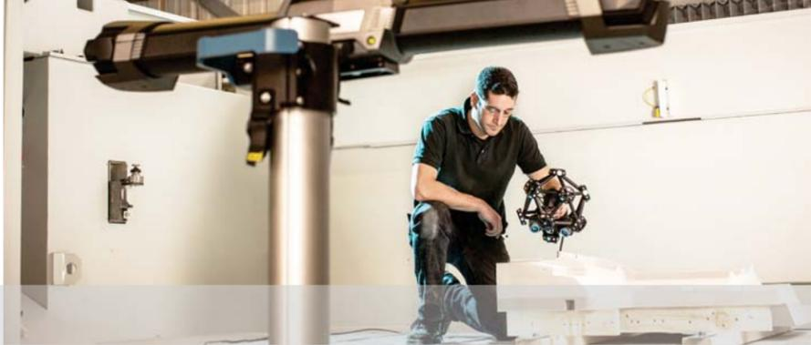
Sin configuración de medición rígida, el escáner **óptico CMM MetraSCAN 3D™** ofrece precisión de medición en la planta de producción que no se ve alterada por las inestabilidades del entorno. Gracias al volumen de medición extensible, la velocidad increíble y la impresionante competencia en cuanto a la adquisición de datos con materiales que representan un desafío, es el escáner 3D de grado de metrología más completo del mercado y una alternativa práctica para las CMM portátiles tradicionales.
