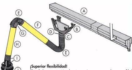
El raíl de evacuación de aire está compuesto de un perfil de aluminio extruido de 5,8 m. de longitud, pudiéndose alargar según las necesidades. Para montaje en techo o pared y según longitud y número de brazos KUA que se necesiten.
