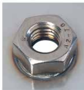
Soldadura de tuercas
