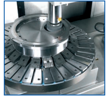
Eje C para el rectificado de piezas no cilíndricas. Asse C per rettifica di forme non cilindriche.
