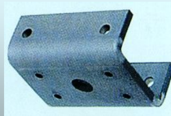
Sin deformaciones en punzonados cercanos a la línea de plegado
