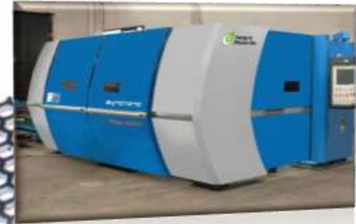
Una línea completa de altas prestaciones para todos los formatos, desde 3.000 X 1.500 mm. Hasta 40 X 3 mts. Aceleraciones desde 1,2 g. a 6 g. Posibilidad de corte inclinado y corte de tubos. Potencias de 2.000 a 5.000 W. Con láser CO<sub>2</sub> y hasta 3.000 W con fibra.
