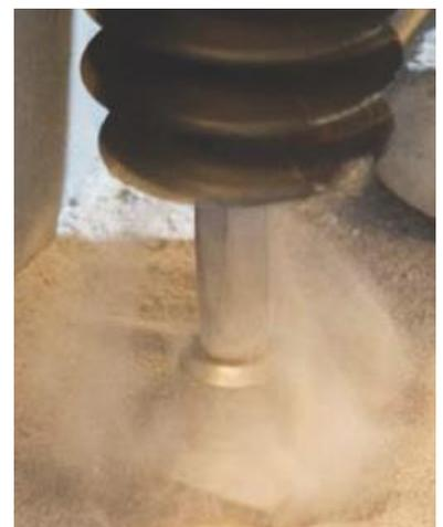
TRABAJO EN MI PUESTO CON MANGUERAS Y COLECTORES EN LA HERRAMIENTA PARA ASPIRAR EL CONTAMINANTE
