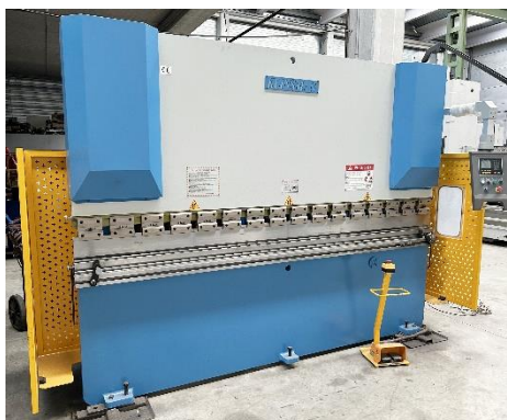
Plegadora KLINSMAN 125/3200. 3200x125 Tn Control E21 a 2 ejes. Matriz multiboca. Punzón. KLINSMAN 125/3200 press brake. 3200x125Tn E21 2-axis control. Multimouth die. Punch.
