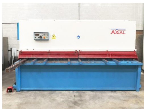
Cizalla AXIALCP 1630. 3100x16mm Con tope trasero digitalizado Hengstler, mesa de bolas, contador de cortes, iluminación línea de corte, etc AXIALCP 1630 shearing machine. 3100x16mm Hengstler digital backgauge, ball table, counter of number of cuts, cutting line lightning, etc
