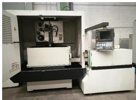
FANUC ROBOCUT ALPHA-0iB. Recorridos: X 320mm Y 220mm U 120mm V 120mm Z 180mm. Control FANUC 180 iS-W. Dimensiones pieza: 600x400x180mm. FANUC ROBOCUT ALPHA-0iB. Travels: X 320mm Y 220mm U 120mm V 120mm Z 180mm. FANUC 180 iS-W control. Workpiece dimensions: 600x400x180mm.
