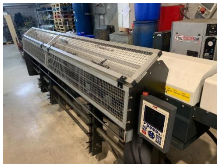
Torno cnc CMZ TC 20 YS. EP 800mm. Ø bancada 920mm. Ø paso de barra 66mm. Año 2016. Control FANUC. Extractor. Brazo de extracción de pieza. Cargador de barras automático LNS. CMZ TC 20 YS cnc lathe. EP 800mm. Swing over bed 920mm. Spindle bore Ø 66mm. Year 2016. FANUC control. Conveyor. Arm of piece extraction. Automatic bar feeder brand LNS.
