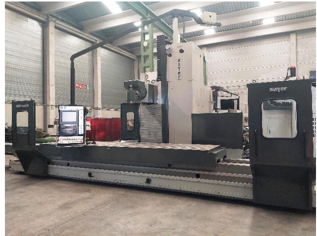
Fresadora bancada fija ZAYER 30KF-5000. CNC HEIDENHAIN TNC 426. Mesa: 5000x1000mm. Recorridos: 4710x1508x2013mm. Cabezal automático 45° (0,001°-0,001°). Extractor de virutas. ZAYER 30KF-5000 bed type milling machine. CNC HEIDENHAIN TNC 426. Table: 5000x1000mm. Travels: 4710x1508x2013mm. 45° automatic head (0.001°-0.001°). Chip conveyor.
