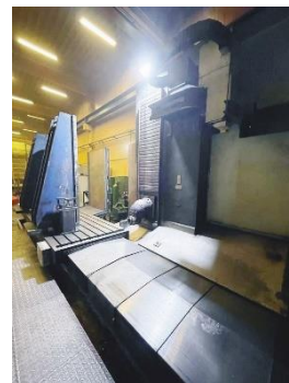
Fresadora de bancada fija SORALUCE TR-35 Mesa: 3860x1200mm. Recorridos: 3500x1300x1800mm Cabezal automático. HEIDENHAIN iTNC 530. 4º eje. SORALUCE TR-35 bed type milling machine Table: 3860x1200mm. Travels: 3500x1300x1800mm Automatic head. HEIDENHAIN iTNC 530 control. 4th axis.
