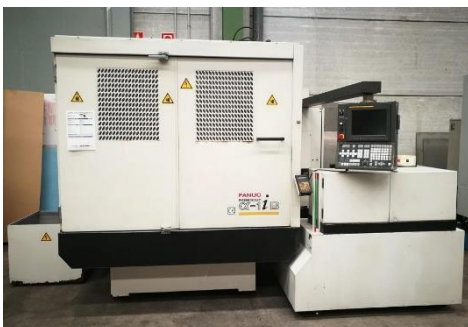
FANUC ROBOCUT ALPHA-0iB. Recorridos: X 320mm Y 220mm U 120mm V 120mm Z 180mm. Control FANUC 180 iS-W. Dimensiones pieza: 600x400x180mm. FANUC ROBOCUT ALPHA-0iB. Travels: X 320mm Y 220mm U 120mm V 120mm Z 180mm. FANUC 180 iS-W control. Workpiece dimensions: 600x400x180mm.
