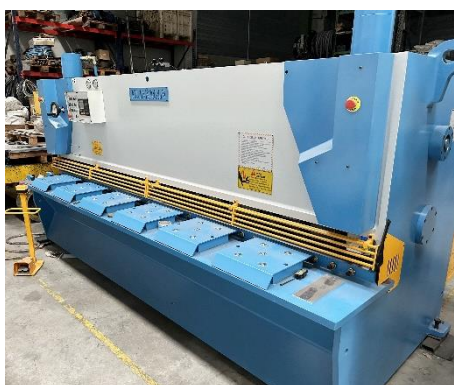
Cizalla KLINSMAN RPG3206. 3200x6mm Con control numérico E21S a 1 eje (tope trasero) Cuchillas de 4 caras y 3 brazos frontales. KLINSMAN RPG3206 shearing machine. 3200x6mm E21S numerical control 1 axis (backgauge) 4 sided blades and 3 front arms
