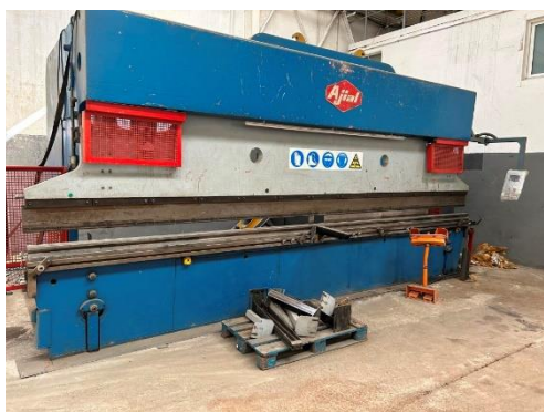
Plegadora AJIAL 2414. 6050x240 Tn Control CYBELEC CYBTOUCH 8 (2 ejes - X,Y) Mesa de compensación manual. 3 brazos. Matriz. AJIAL 2414 press brake. 6050x240Tn CYBELEC CYBTOUCH 8 control (2 axes - X,Y) Manual compensation table. 3 arms. Mouth die.
