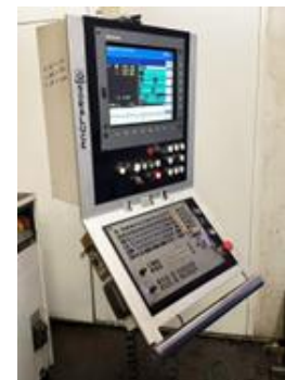
Fresadora de bancada fija SORALUCE TR-35 Mesa: 3860x1200mm. Recorridos: 3500x1300x1800mm Cabezal automático. HEIDENHAIN iTNC 530. 4º eje. SORALUCE TR-35 bed type milling machine Table: 3860x1200mm. Travels: 3500x1300x1800mm Automatic head. HEIDENHAIN iTNC 530 control. 4th axis.
