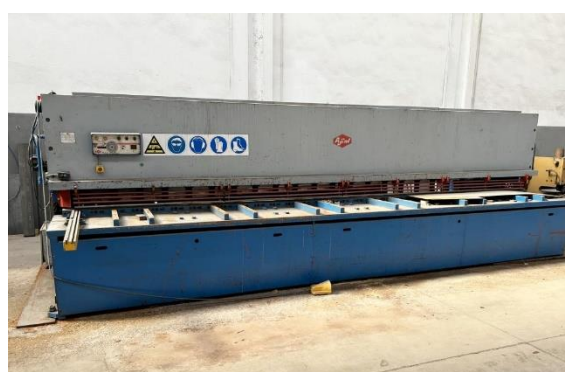
Cizalla hidráulica AJIAL CS-650. 6100x6mm Equipada con mesa de bolas, juego de cuchillas, consola, iluminación de línea de corte, etc AJIAL CS-650 hydraulic shearing machine Equipped with ball table, blade set, console, cutting line lightning, etc.
