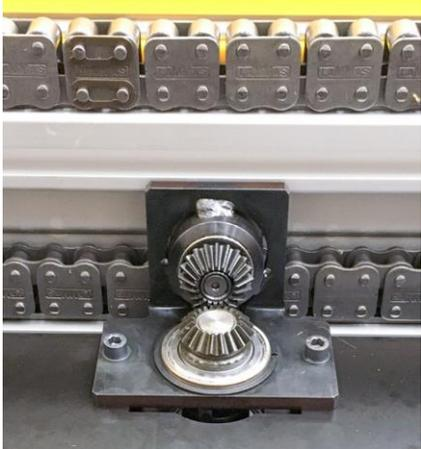
Este dispositivo inteligente se aplica en la unidad de transferencia y da la ventaja de ahorrar un motorreductor para el movimiento de transferencia ortogonal. El engranaje mantiene el movimiento de la cadena principal del módulo. Cuando la unidad de transferencia se eleva un acoplamiento mecánico transfiere el movimiento a las cadenas de la unidad de transferencia moviendo el palet ortogonalmente.
