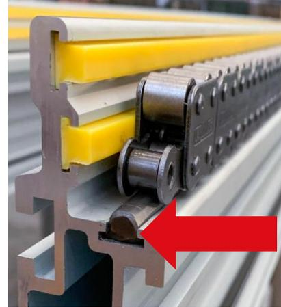
La cadena se desliza sobre guías en T de acero templado, que garantizan la robustez y durabilidad del transportador incluso en presencia de pesos elevados.
