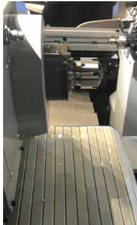
Persiana faldón modelo PHR-ENR montada en máquina
