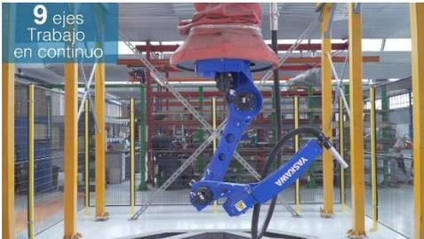
**Leyenda:** Eseki ha diseñado y puesto en marcha el primer robot granalladora con 9 ejes de movimiento para granalla angular, flexible y modular, programado offline en 3D.
